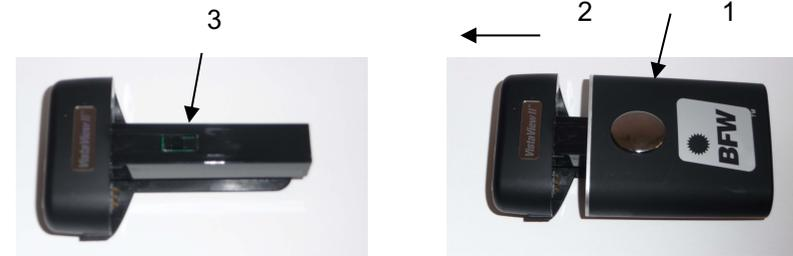
Zum Betrieb Kabel der LED Optik mit dem Verlängerungskabel verbinden, dieses in das Steuergerät einstecken.
